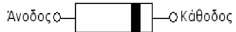
Σχήμα 2. Η επαφή PN. Αντιστοιχία με το κυκλωματικό σύμβολο της διόδου και με την πραγματική της απεικόνιση.
