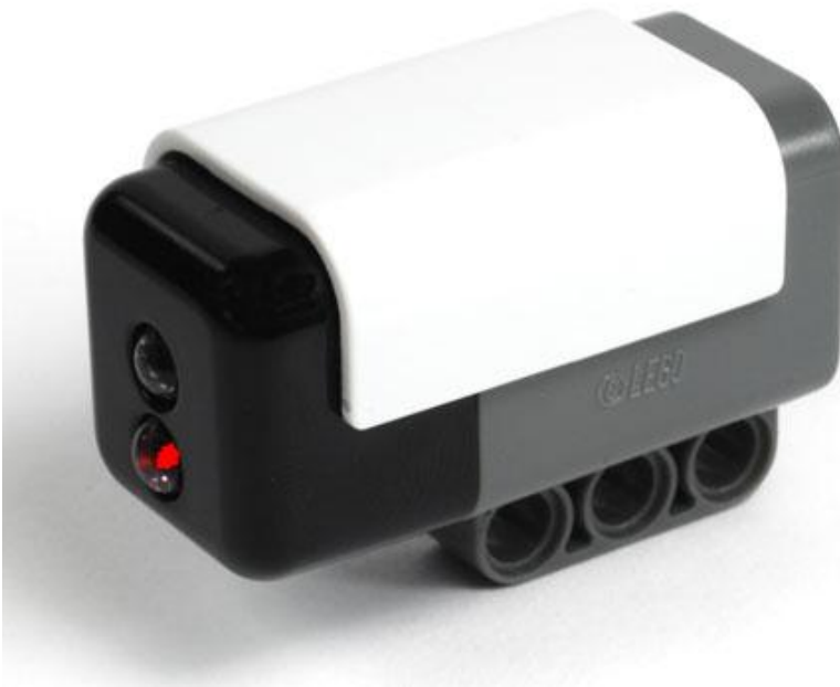
Σχήμα 1 : Αισθητήρας εντάσεως φωτισμού ( κάτω δεξιά βλέπουμε την δίοδο εκπομπής φωτός , ενώ ακριβώς πάνω από αυτήν το σημείο καταγραφής του αισθητήρα)
